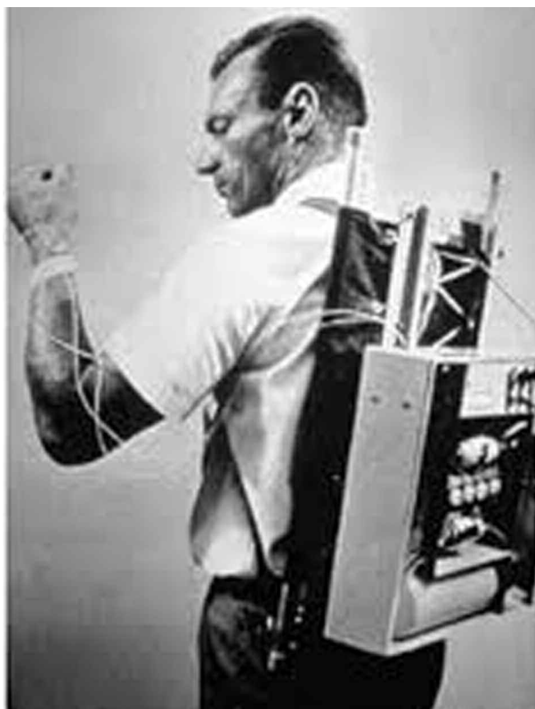
Η φορητή αντλία ινσουλίνης του Dr Arnold Kadish, που χρησιμοποιήθηκε για πρώτη φορά στο Λος Άντζελες το 1963, δεν βοήθησε τους διαβητικούς, διότι, αν και λειτουργική, εγκαταλείφθηκε λόγω μεγάλου βάρους και όγκου.
